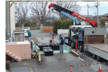
お客様の計量業務を極力中断しないタイミングで、法定の定期検査(計量士による代検査)を実施いたしますので、お気軽にご相談ください。
