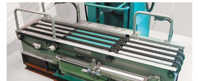
容器搬送コンベヤ
