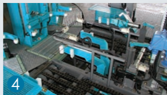
4 自動搬入搬出装置
