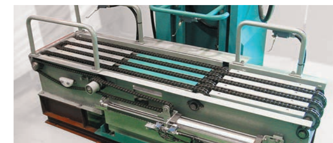
容器搬送コンベヤ
