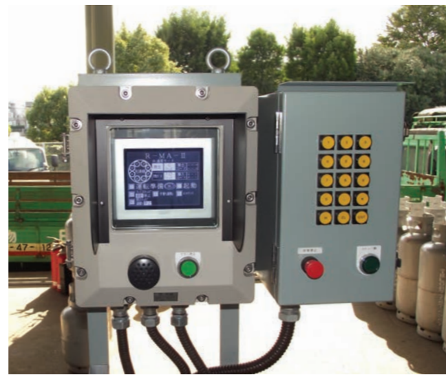
システム全体を一括コントロールできる現場操作盤
