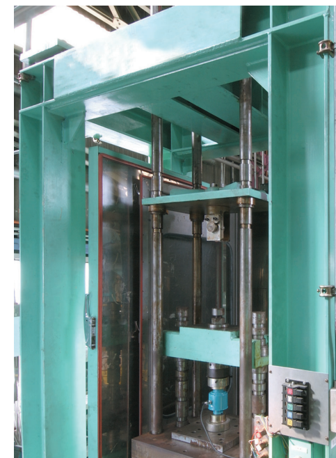
50t荷重試験機(1号機)
